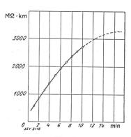
Fig. 4. Mesure de l'isolement du câble.
