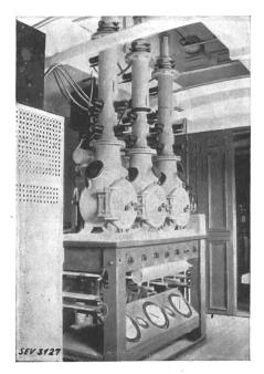
Fig. 13. Vue de l'oscillographe cathodique tripolaire.
