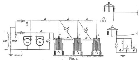
Schéma de couplage de l'installation génératrice de chocs.
