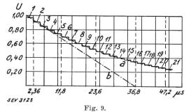
a Courbe calculée de la tension aux bornes du générateur de chocs sur une ligne de longueur infinie. Les nombres en regard des différents paliers sont les numéros d'ordre des ondes de décharge dans le cêble.
