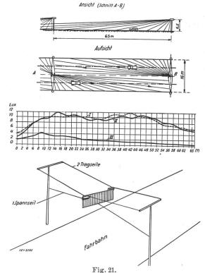
Horizontal- und Vertikal-Beleuchtung der Hauptstrasse Köln-Bonn (Fahrbahnbreite 16 m) durch Ueberspannlampen mit Zeiss-Ikon-Autostrassenleuchte Z-Form,
