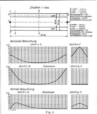
Horizontal- und Vertikal-Beleuchtung einer Hauptstrasse von 15 m Breite (9 m Fahrbahn, 2 Troittoirs zu 3 m) durch Ueberspannlampen mit Belmag-Freistrahlern 9001, besteckt mit je einer Klarglas-Glühlampe 500 W, 8680 int. Lumen. Brennpunkthöhe = 9,5 m; beleuchtete Fläche pro Lampe = 765 m²; spezifische Leistung = 0,634 W/m².
