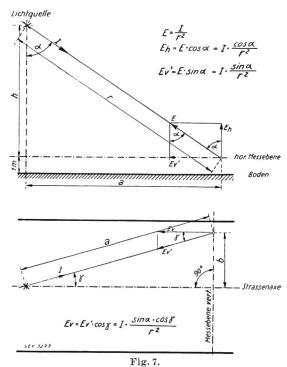
Berechnung der Horizontal- und Vertikal-Beleuchtung mit dem Punktverfahren.
