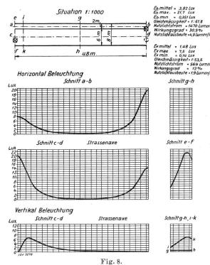
Horizontal- und Vertikal-Beleuchtung einer Quartierstrasse von 8 m Breite (6 m Fahrbahn, 1 Trottoir zu 2 m) durch Bogenkandelaber mit LAG-Breitstrahlern SBI 45, besteckt mit je einer Klarglas-Glühlampe 300 W, 4760 int. Lumen. Brennpunkthöhe = 7,5 m; beleuchtete Fläche = 384 m²; spezifische Leistung = 0,781 W/m².
