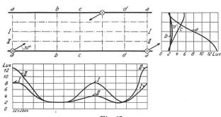
Fig. 17. Längs- und Querdiagramme der Versuchsstrecke Schlieren. I in Axe I-I II in Axe II-II a in Axe a-a usw.
