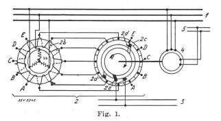
Umformer. Die Mehrphasenwicklung ist durch die Dreiphasenwicklung 2 a dargestellt, 2 b ist die Ankerwicklung, 2 c der zugehörige Kommutator, 2 d der rotierende Bürstenapparat und 2 e sind Hilfsbürsten, die den gleichgerichteten Strom dem Gleichstromnetz 3 zuführen. Der Rotor des Antriebsmotors 4 wird von der Hilfsgleichstromquelle 5 gespeist. Das Anfahren des Antriebsmotors kann mit Hilfe einer Dämpferwicklung geschehen.
