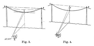
genannten Theodoliten stets ausführbar. Ein wesentlicher Vorteil bei Anwendung dieses Instrumentes besteht darin, dass man auf die Geländeform keine Rücksicht zu nehmen braucht, da die Messung statt auf schlecht bestimmbare Geländepunkte auf die Verbindungslinie AB bezogen wird.
