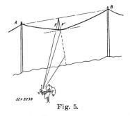
chend dem Masse der Ueberhöhung, zu neigen ist, bis sie parallel zur Verbindungslinie der Aufhängepunkte steht. Die zueinander rechtwinklig angeordneten Achsen des dritten Theo-
