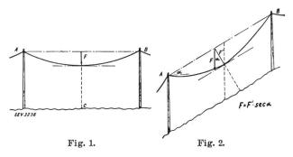
und im zweiten dem oberen Aufhängepunkt genähert. Das Mass der Näherung und der Durchhang selbst sind bei überhöhter Aufhängung nur durch besondere Methoden festzustellen.
