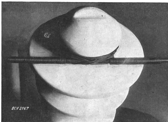
Fig. 2. Telegraphenbund. Pro Bund sind 2×3 m Binddraht von 2,5 mm \varnothing nötig.
