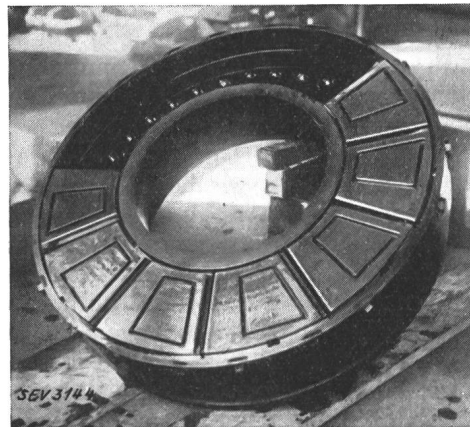
Fig. 9 Unterer Spurring zu einem BBC-Generatorspurlager.
