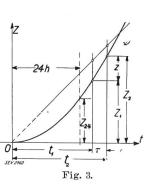
zu zerlegen. Für die Bestimmung der spezifischen Eislast wird dann derjenige Zeitabschnitt ausgewertet, welcher die maximalen Werte ergeben hat 1). Für diese Auswertung haben wir  $Z = k \cdot t^2$  angenommen; es könnte hiefür aber auch ein anderer als quadratischer Exponent eingesetzt werden.
