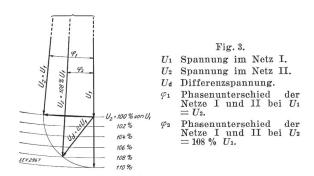
Aus Fig. 3. erkennt man weiter, dass der maximal zulässige Spannungsunterschied sich bei gleichbleibendem Ansprechwert des Spannungsrelais nur recht unbedeutend ändert, wenn beide Spanungen  $U_1$  und  $U_2$  zugleich grösser oder kleiner werden.
