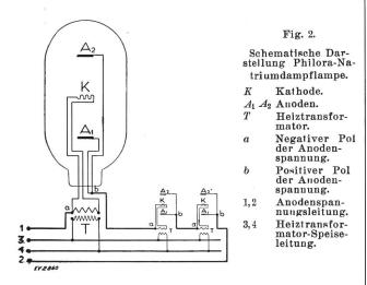
bis 7000 Hefnerlumen und die Leuchtdichte ist von der Grössenordnung 8 Hefnerkerzen pro cm². Vom Licht der bisherigen Glühlampe, abgesehen von der 3- bis 5fachen Lichtausbeute, unterscheidet sich das Natriumlicht durch ganz besondere Eigenschaften, die sich in erster Linie aus der nahezu monochromatischen Beschaffenheit desselben erklären. Es darf daher nicht ohne weiteres mit demjenigen der Glühlampe verglichen werden.
