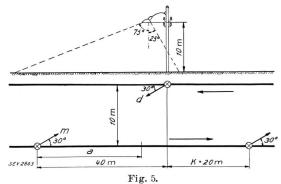
Anordnung der Beleuchtungspunkte. m, d Projektionen der Reflektorachsen.
