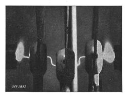
Fig. 10. Forschungsversuch von Lotz. Einengung des Lichtbogens durch Blenden mit Wasserschleier.
