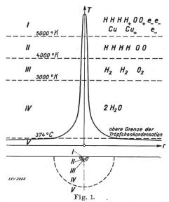
Temperaturverlauf im Wasserdampflichtbogen.
