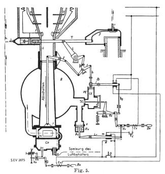
Schematische Darstellung des mechanischen Teils eines Druckluftschalters.
