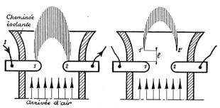
Fig. 8. Schematische Darstellung der Blaswirkung im Luftschalter.
