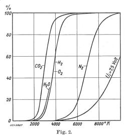
Beziehungen zwischen Lichtbogentemperatur und Dissoziation des Löschmittels.
