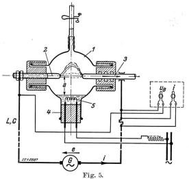
Versuchsanordnung für Lichtbogenmessung.
