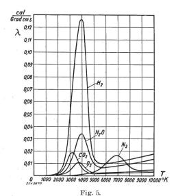
Wärmeleitfähigkeit von Gasen bei hohen Temperaturen.
