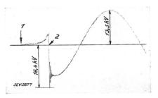
Fig. 7. Kathodenstrahloszillogramm des Spannungs-Verlaufs im Augenblick der Stromunterbrechung.  $\begin{array}{c} U=9500~V_{\text{eff}} & \text{fo} \\ 1~Trennung~der~Kontakte.} \\ 2~Stromunterbrechung. \end{array}$ I = 2200 A $f_0 = 10000 \text{ Per./s.}$
