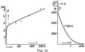
Durchmesser und Temperaturabfall im elektrischen Lichtbogen.
