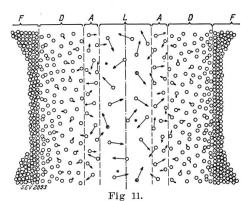
Schematische Darstellung des Lichtbogens in einer Flüssigkeit. L Lichtbogen. D Dampfzone. A Abkühlungszone. F Flüssigkeitszone.
