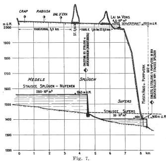
Projekt für die Ausnutzung der Hinterrhein-Wasserkräfte. Nebenkraftwerk Lai da Vons-Sufers. Maßstab: Horizontal 1:375000; Vertikal 1:37500.
