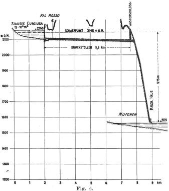
Projekt für die Ausnutzung der Hinterrhein-Wasserkräfte. Nebenkraftwerk Curciusa-Nufenen. Maßstab: Horizontal 1:375000; Vertikal 1:37500.
