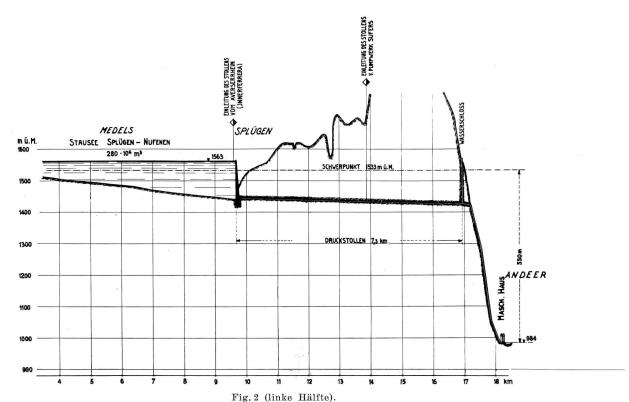
Projekt für die Ausnutzung der Hinterrhein-Wasserkräfte. Gefällstufe Splügen-Andeer.
