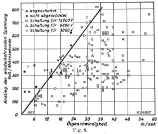
Zulässige Anstieggeschwindigkeit der wiederkehrenden Spannung, abhängig von der Oelgeschwindigkeit für verschiedene Spannungen.
