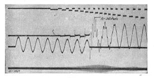
Oszillogramm einer Abschaltung von 2700 A eff bei 84,6 kV, f=50 Per./s, in einem Stromkreis, dessen Eigenfreunenz  $f_0=340$  Per./s ist.
