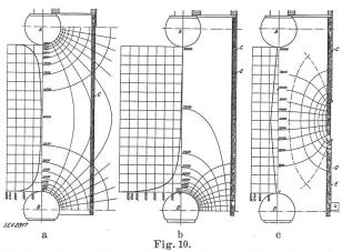
Elektrostatische Feldverteilung zwischen zwei Kugelkontakten bei 8000 V im Augenblick des Austretens des beweglichen Kon-taktes (B) aus dem Bitubazylinder. Die Kurve links stellt die elektrische Beanspruchung in V/em dar.
