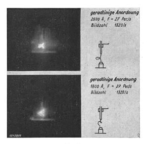
Fig. 3b. Zeitlupenaufnahmen vom Wechselstromlichtbogen in Luft. Bildfrequenz: 1320/s;  $I=2500/1800~\mathrm{A};~f=27~\mathrm{Per./s}.$  Elektroden: Klotzkontakte aus Kupfer; geradlinige Strombahn.
