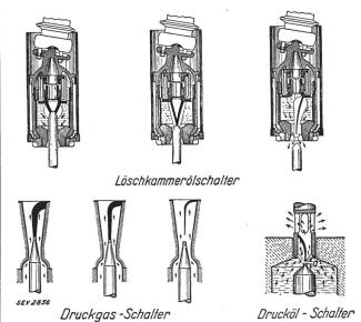
${\bf Fig.~2.}$  Lichtbogenunterbrechung im Hochleistungsschalter.
