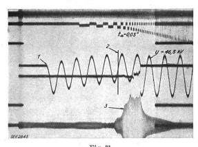
Fig. 31.  $\begin{array}{c} \text{Oszillogramm einer Abschaltung von 5300 A}_{\text{eff}} \text{ bei} \\ \text{46,5 kV wiederkehrender Spannung: } f = 50 \text{ Per./s,} \\ \text{mit dem Schalter nach Fig. 30.} \\ 1 \text{ Beginn des Kurzschlusses.} \\ 2 \text{ Beginn der Abschaltung.} \\ 3 \text{ Druckverlauf.} \end{array}$
