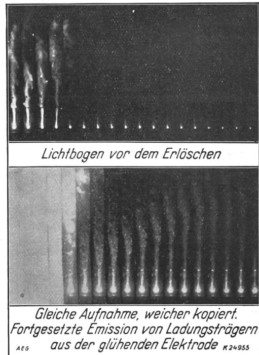
Fig. 6. Unterbrechungsvorgang im Druckgasschalter.
