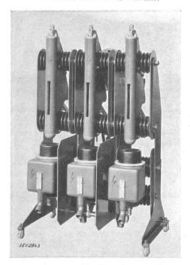
Fig. 29. Bpoliger Wasserschalter (Expansionsschalter) für 11 kV mit durch Ventile entlasteter Dampfkammer.
