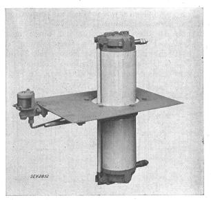
Fig. 38. Einpoliger Druckluftschalter mit doppelter Unterbrechung für 24 kV und 6 kg/cm² Ueberdruck. Der Schalter dient gleichzeitig als Durchführung.
