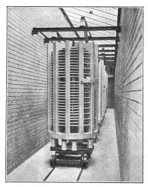
Fig. 10. Reaktanzen zur Strombegrenzung im Kurzschlussversuchsfeld der AEG-Transformatorenfabrik.
