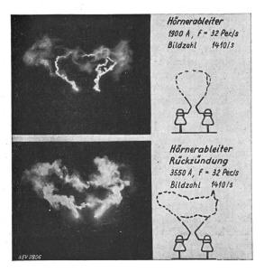
Zeitlupenaufnahmen vom Wechselstromlichtbogen in Luft. Bildfrequenz: 1410/s; I=1900/3550 A; f=32 Per./s. Elektroden: Hörner aus Kupfer.
