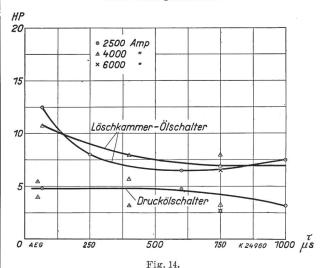
Einfluss der Netzkapazität auf die Lichtbogendauer beim Löschkammer- und Druckölschalter.
