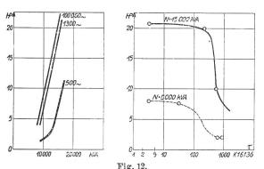
Einfluss der Netzkapazität auf die Lichtbogendauer bei einem Oelschalter.
