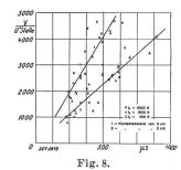
Zündspannung pro Unter-brechungsstelle in Funktion der Verfestigungszeit 1 Kontaktabstand 3 cm. 2 Kontaktabstand 2 cm.
