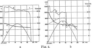
Verlauf der spezifischen Lichtbogenspannung (V/cm) während einer Halbwelle nach der Auswertung der Zeitlupenaufnahmen vom Wechselstromlichtbogen in Luft.
