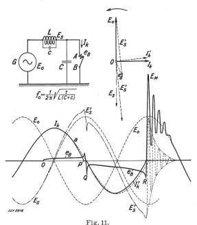
Verlauf der wiederkehrenden Spannung nach dem Abschalten eines Kurzschlusses im induktiven Kreis.
