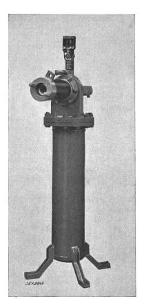
Fig. 32. Einpoliger Druckluftschalter mit offenem Auspuff zur Erfor-schung der Abschaltvorgänge.
