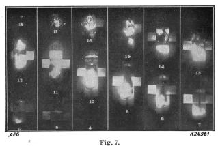
Lichtbogenunterbrechung im Oelschalter mit offenen Kontakten. 6 kV, 50 A,  $\cos \varphi = 0.45$ .
