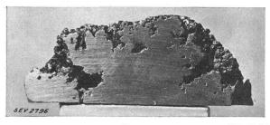
Fig. 12. Coupe à travers un morceau d'aube corrodée par cavitation (fonte de fer).
