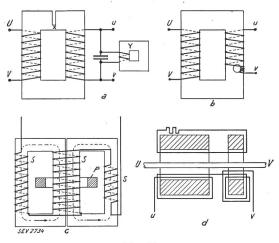
Fig. 27. Kunstschaltungen. a Nach Pfiffner. c Nach AEG. b Nach Wilson. d Nach Wellings und Mayo.
