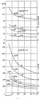
Fig. 5. Fehlerkurven eines 200/5-A-Wandlers bei cos =1. Oben Uebersetzungsfehler in  $\vartheta_0$  ( $\tilde{\omega}^2$  $\vartheta_0$ , resp.  $\Delta \tilde{\omega}^2 \vartheta_0$ /VA), unten Winkelfehler in Minuten Voreilung ( $\theta$  resp.  $\Delta \theta$ /VA), in Funktion des Sekundärstromes (A). Kernmaterial: Legiertes Eisen. D=38 cm, H=18 cm.
