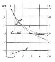
Fig. 37. Fehlerkurven ( $\triangle \ddot{u}^{0}/_{0}$  und  $\theta$ ') des 400/5-A-Wandlers. D = 44 cm, H = 18 cm.Gewicht = 120 kg. Bürde = 0 bis 50 VA für  $\cos \varphi$  im Bereich von Fig. 39a.
