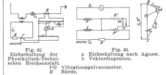
wiedergegeben und bedarf keiner weiteren Erläuterung. Eine ähnliche Kompensationsmethode von Agnew ist in Fig. 43 dargestellt; sie hat den Vorteil, dass die Fehlergrössen in einfacherer Weise aus der Schaltung hervorgehen. Stromlosigkeit im Vibrationsgalvanometer (VG) wird durch passende Einstellung der Widerstände R' und R" und der gegenseitigen Induktion M erzielt. Uebersetzungsfehler und Fehlwinkel sind aus Fig. 43 b gegeben durch:
