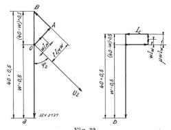
Fig. 32. Diagramm des fehlerlosen Wandlers.
