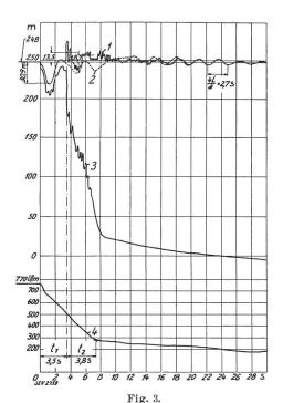
Abschaltversuch an einer Pumpe des Kraftwerkes Wäggital mit Rückschlagklappe ohne hydraulischen Katarakt.
