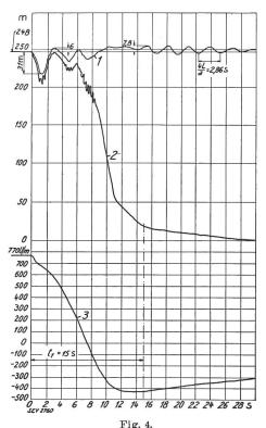
Abschaltversuch an einer Pumpe des Kraftwerkes Wäggital ohne Rückschlagklappe (Schliessung durch den Pumpenschieber) Betriebsverhältnisse vor dem Schliessen: Q = 1365 l/s; H = 256 m; P = 4471 kW.
