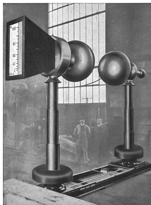
Fig. 9. Statisches Voltmeter von Trüb, Täuber & Cie. für 1 Million Volt.
