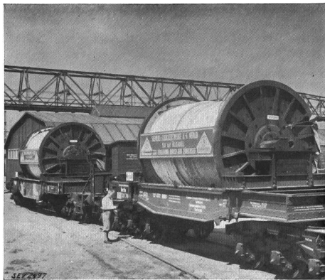
Fig. 4. 60-t-Spezialeisenbahnwagen für Kabeltransport.
