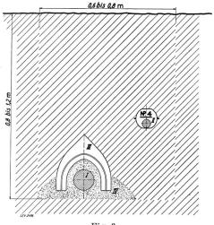
Fig. 3. Kabelgraben Drahtzug-Seefeldquai. 50-kV-Kabel. Telephon-, Signal- und Fernmesskabel. Formstein Hunziker Mod. No. 11.
