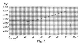
tg  $\delta$  bei 22° C in Funktion der Spaunung der drei verbundenen Adern gegen Erde. (Abnahmeversuch in den SSW, Berlin.)
