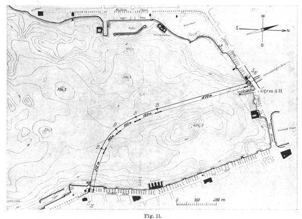
Topographie des Seebeckens, mit eingezeichnetem Trasse des 50-kV-Kabels und den für die Verlegung gesetzten Bojen (B).
