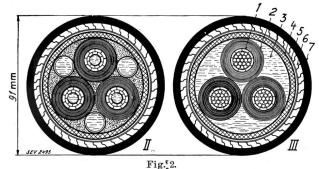
Kabelquerschnitte der Projekte 1929 bis 1931. I Projekt 1929. Massekabel  $3 \times 240 \text{ mm}^2$ . II Projekt 1930. Oelkabel mit besonderen Oelkanälen und Jute-
