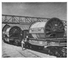
Fig. 4. 60-t-Spezialeisenbahnwagen für Kabeltransport.
