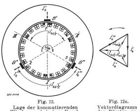
Lage der kommutierenden Windungen bei einer Durch-messerwicklung mit dreipha-sigem Bürstensatz.
