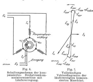
Läuferwicklung die für Kommutator- und Schleifringseite gemeinsame Hauptfeldspannung:
