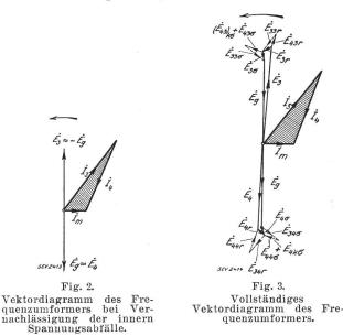
Bürstenseite dieselbe Wirkung wie (doppelt verkettete) Streufelder. Analog erzeugen die durch die Bürstenströme erregten Oberfelder nur zwischen den Bürsten Spannungen der Betriebsfrequenz  $\omega_4$ , während sie für die Schleifringseite wie (doppelt verkettete) Streufelder wirken. Die doppelt verkettete Streuung ist somit beim Frequenzumformer in derselben Weise wie beim Asynchronmotor zu definieren und zu berechnen  $^1$ ).
