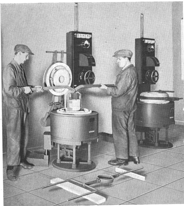
Fig. 19. Elektrische Einsatz-Glüh- und Schmelzöfen der Maschinenfabrik Oerlikon.
