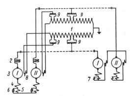
Fig. 1. Schaltung der Lötschberg-Lokomotive (rechts Motor-, links
