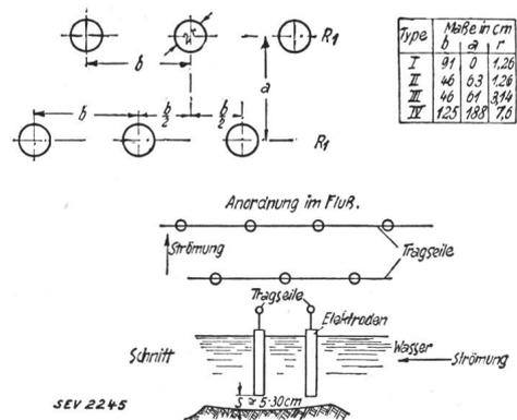
Fig. 1. Abmessungen und Anordnung amerikanischer Ausführungen von elektrischen Fischrechen<sup>1)</sup>.
