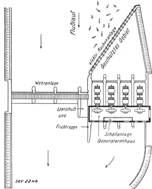
Fig. 2. Projekt eines Kraftwerkes mit eingebauter elektrischer Rechenanlage<sup>2)</sup>.
