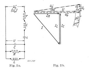
Zur Deckung dieses Blindverbrauchs legen wir eine weitere Kapazitanz  $\frac{1}{\omega c} = \omega l$  an, diesmal in Reihe mit der Leitung, und führen damit im Spannungspolygon einen dem Abfall  $U_1$  entgegengerichteten, gleichgrossen Vektor  $U_c$  ein. Der Strom ist nun mit allen Spannungen in Phase, die Verluste sind mit  $U_r$  minimal, desgleichen der Spannungsabfall  $\Delta U'' = U_r$ .
