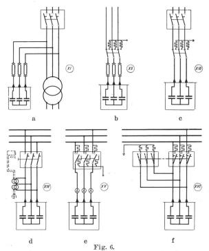
Schemata für den Anschluss von Hochspannungskondensatoren.
