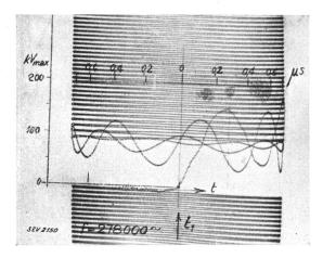
Fig. 7. L'onde du générateur d'impulsion connecté d'après le schéma de la fig. 6.
