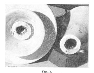
Isolateur No. 3. Perforation de la jupe inférieure survenue au cours des essais d'impulsion avec l'onde non amortie de 432 kV<sub>max</sub>,  $\beta=2,27$ .
