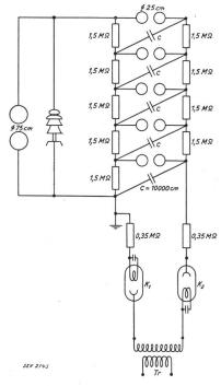
Fig. 2. Connexions du générateur d'impulsion à 5 étages pour 1 250 000 V.
