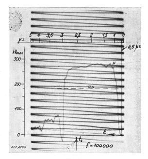
Fig. 21. Oscillogramme cathodique de l'onde d'impulsion amortie produisant un contournement de l'isolateur No. 8.  $t=2~\mu \text{s},~\beta=1,51,~a=0,72.$
