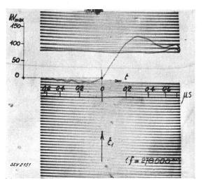
Fig. 8. L'onde du générateur d'impulsion connecté d'après le schéma de la fig. 6. Résistance en série: 400 Ohm.
