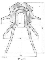
Isolateur rigide de 50 kV tension nominale (Nos. 8, 9 et 12).
