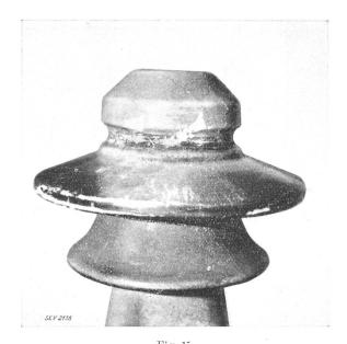
Fig. 15. Isolateur No. 7. Perforation par la tête de l'isolateur, survenue au cours des essais d'impulsion avec l'onde non amortie de 360 kV<sub>max</sub>,  $\beta=1,$ 57.
