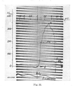
llogramme cathodique de l'onde d'impulsion amortie produisant un contournement de l'isolateur No. 9.  $t=0.85~\mu\text{s},~\beta=1.83,~a=0.76.$
