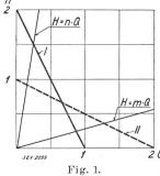
Unterdruckkurven eines Hochund eines Niedrigvakuumstaubsaugers.
