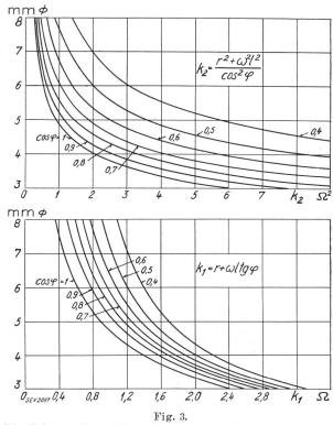
Die Faktoren  $k_1$  und  $k_2$  in Funktion des Drahtdurchmessers und der Phasenverschiebung.
