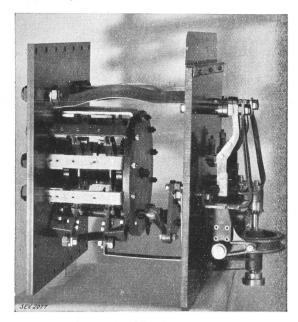
Fig. 8. Zusammenstellung von Zwillingsumschalter und Schütze für einen Einphasentransformator, aus dem gemeinsamen Oelkasten herausgehoben.
