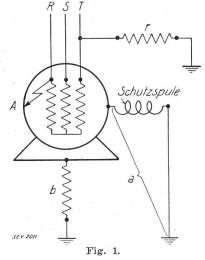
Schutzspule seines Schutzschalters besitze zusammen mit ihrer Hilfserdung einen Widerstand a. Der Widerstand des Motorgehäuses gegen Erde sei b. Es entstehe ein voller Körperschluss (Durchschlag) zwischen der Phase R des Motors und dem Gehäuse in Punkt A. Gleichzeitig besitze die Phase T des Netzes einen Gesamtwiderstand r gegen Erde.
