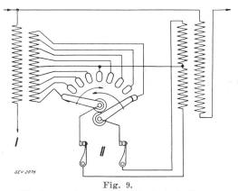
Einphasenschema für Vollastumschaltung nach der Doppeltransformationsmethode. Schaltgeräte in unabhängigem Stromkreis. I Zum Sternpunkt oder zur Erde.
