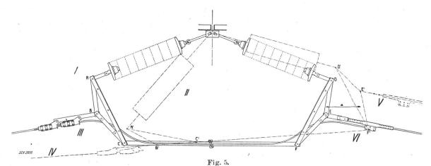
150-kV-Halbabspannung mit Trapez. Maßstab ca. 1:40.
