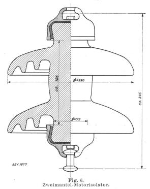
Es sind dies Werte, die weit unter denen liegen, welche bei den übrigen Kettenisolatorentypen bei Ueberschlag auftreten und welche die vollständige Durchschlagsicherheit der Motorisolatoren erkennen lassen.
