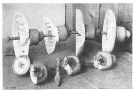
Fig. 2. Infolge Durchschlag der Elemente zerstörte 4 gliedrige Ketten aus Kappen-Bolzen-Isolatoren, welche mit 50 kV in Betriebzwaren.
