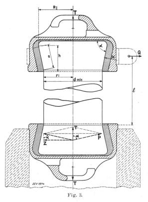
Die Ausbildung der Einspannenden und der Fassungsorgane ist von ausschlaggebender Bedeutung für den Grad der Nutzbarmachung der im Isolierkörper vorhandenen Zugfestigkeit. Die besten Resultate werden mit am keramischen Teil konisch nach aussen verdickten Einspannköpfen und darüber gesteckten Eisenkappen, welche entsprechend konische Hohlräume besitzen und gut zentrisch mit einer Bleilegierung vergossen werden, erreicht (Fig. 3).
