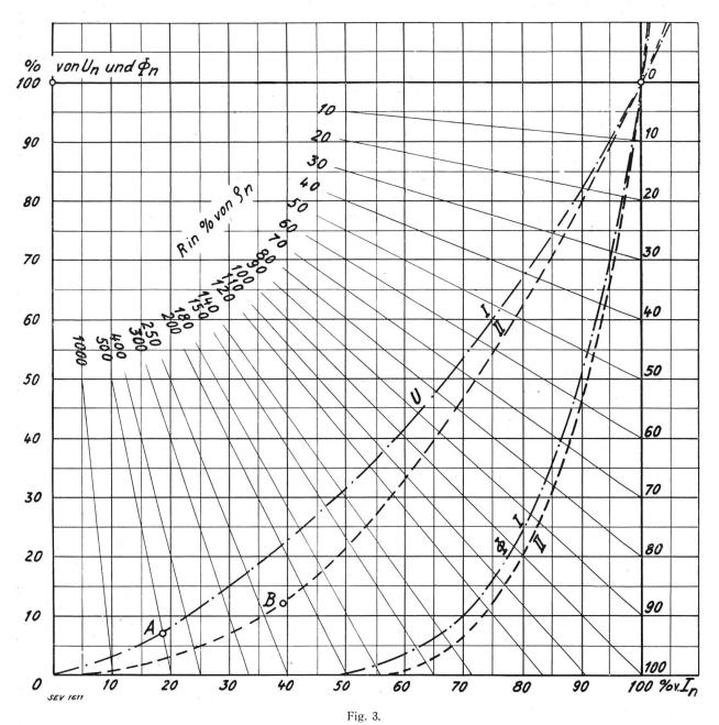
Lichtstrom  $\Phi$  und Spannung U in Funktion der Stromaufnahme I, in 0/0 der Nennwerte. I Kurven für luftleere Lampen ; II Kurven für gasgefüllte Lampen.
