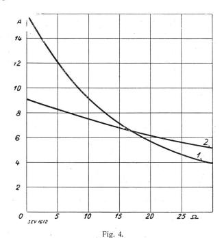
Stromzunahme in Funktion des Regulierwiderstandes. Kurve 1 2000 W bei 125 V; Kurve 2 2000 W bei 220 V.
