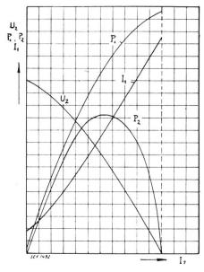
Fig. 1. Charakteristische Kurven eines kurzschlussicheren Transformators mit Widerstandsabgleichung, Methode 1.
