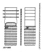
Fig. 2. Schutzring, der Oberspannungswicklung vorgeschaltet.
