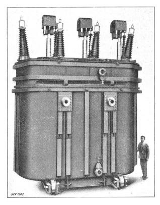
Fig. 8. Drehstromtransformator mit künstlichem Oelumlauf und Wasserkühlung mit Regulierung unter Last, 20 000 kVA, 50 Per/s,  $\frac{150}{47,85} + \frac{1}{4} \times \frac{1,7/8}{4}$  kV.
