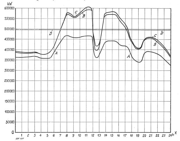
Leistung der Flusskraftwerke . . . . . . . .  $= OX \cdot A = Pu$ issance utilisée dans les usines au fil de l'eau. Leistung der Saisonspeicherwerke . . . . . .  $= A \cdot B = Pu$ issance utilisée dans les usines à réservoir saisonnier. Leistung der kalorischen Anlagen und Energieeinfuhr .  $= B \cdot C = Pu$ issance produite par les installations thermiques et
