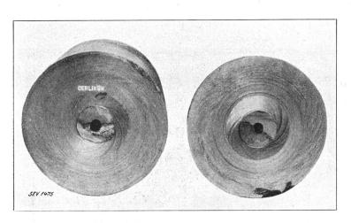
Rotorkörper mit gefährlichem Diametralriss. Fig. 7.
