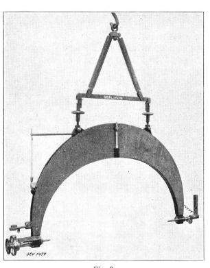
Fig. 9. Grosses Präzisionsmikrometer, System Maschinenfabrik Oerlikon, zur Bestimmung kleinster bleibender Dehnungen an ausgeschleuderten Rotorkörpern.
