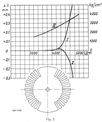
Scheibe von 920 mm Durchmesser. Dehnungen und Spannungen in Funktion der Umdrehungszahl pro Minute. Bleibende Dehnungen im Durchmesser über Polhorn. Bleibende Dehnungen im Durchmesser über Neutrale.
