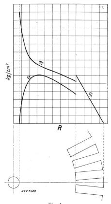
Fig. 1. Verlauf der Beanspruchung in einem gebohrten Rotorkörper in Funktion des Radius.
