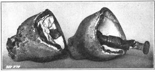
Fig. 5. Durch Lichtbogenüberschlag zerstörte Kappenisolatoren.
