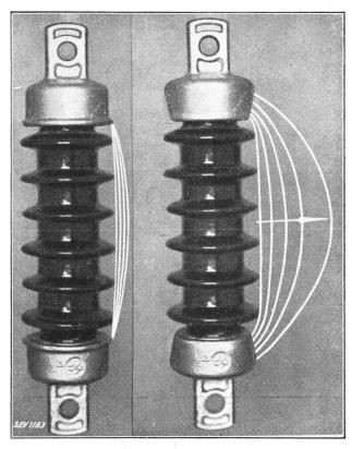
Fig. 9. Schematische Darstellung des Lichtbogenverlaufes an Stabisolatoren mit günstigen und ungünstigen Kappen.
