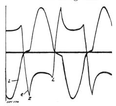
Fig. 2. Dynamische Charakteristik des Lichtbogens: Z Zündspitze L Löschspitze
