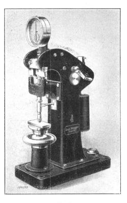
Fig. 2. Kugeldruckpresse von Schopper, mit 4 Druckkraftstufen.
