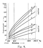
Eindrucktiefe in Funktion der Prüfbelastung bei verschiedenen Prüfzuständen. Hartpapierröhren. Dicke 20 mm. Kugel 10 mm. Innenwerte.
