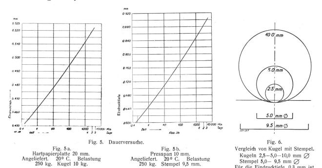
Prüfdauer: Aus den verschiedenen im weiteren Zusammenhange noch erwähnten graphischen Darstellungen und unter Berücksichtigung der unter den Vorproben bereits erwähnten Formel  $y = a \cdot \log x + b$  ergibt sich die Forderung für die Dauer
