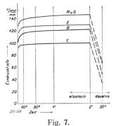
Elastische und dauernde Verformung, Hartpapierröhren. 10 mm Kugel. Belastung 250 kg. Innenwerte.
