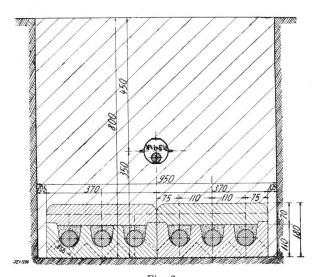
Fig. 3. Kabelgraben Manegg-Selnau.
