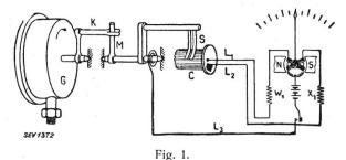
Fernübertragung von Hartmann & Braun mit Schleifkontakt am Geber und Kreuzspulinstrument als Empfänger.
