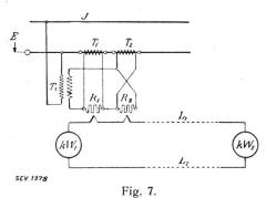
Schema der Fernübertragung mit Thermumformer nach dem Verfahren von Fawsett und der Cambridge Instrument Co.
