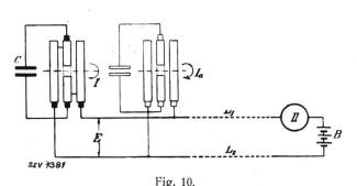
Schema der Fernmessung nach dem Impulsfrequenz-Kondensatorverfahren.
