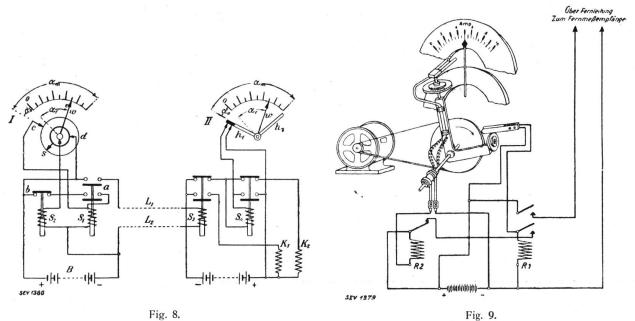
Schema der Fernübertragung nach dem Impulszeitverfahren der Deutschen Telephonwerke und Kabelindustrie A.-G., Berlin.
