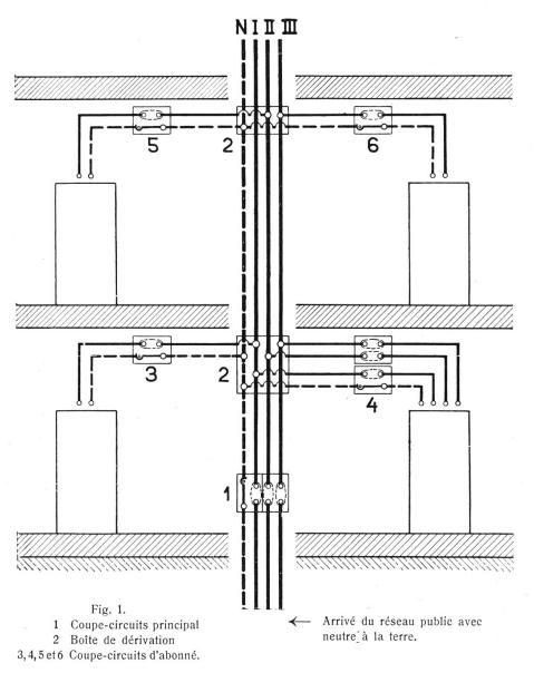
coupe-circuits, l'un monté avec fusible, l'autre avec bouchon-connexion, dans les installations réalisées suivant le schéma III du § 18 des prescriptions citées plus haut, par un coupe-circuit unique sur la phase, muni d'un dispositif de sectionnement non fusible pour le neutre.
