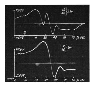
Fig. 46. Fig. 47. Beanspruchung eines 20 kV-, 200 kVA-Transformators bei der Sprungwellenprobe.
