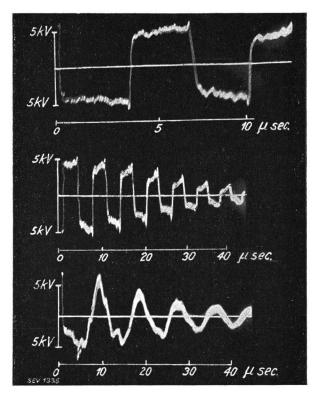
Fig. 25. Fig. 26. Entladeschwingung beim Kurzschluss einer 500 m-Freileitung.
