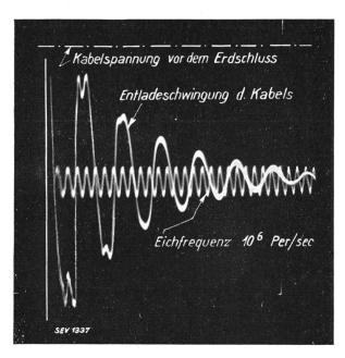
Fig. 27. Entladeschwingung beim Erdschluss eines einpoligen Kabels.
