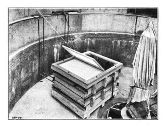
Fig. 6. Verstärkte und versenkte Prüfkiste, versuchsbereit, geöffnet.
