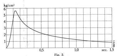
Druckverlauf in Funktion der Zeit bei scharfem (8 %)0) Methan-Luftgemisch.
