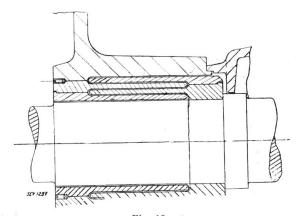
Fig. 10. Wasserstoffsicherer Labyrinthspalt für die Wellendurchführung.
