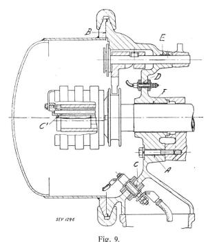
Schlagwettersichere Kapselung aussenliegender Schleifringe im Schnitt.
