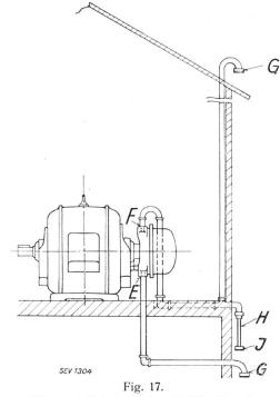
Wasserstoffschutz durch natürliche Kapselentlüftung.
