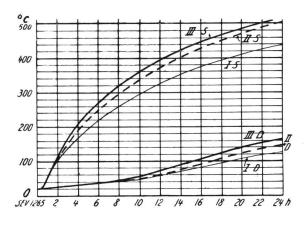
Fig. 9. Verlauf der Temperaturen im Therma-Speicherherd, System Seehaus, bei 24stündiger Aufladung mit den Belastungen I, II und III in Fig. 10. Kurven S Temperaturen im Speicherherd Kurven D Temperaturen im Druckraum
