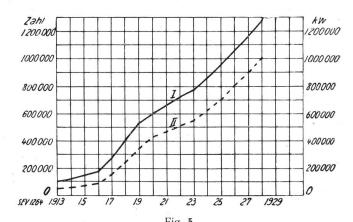
Zahl (Kurve I) und Anschlusswert (Kurve II) der in der Schweiz in den Jahren 1913 bis 1928 angeschlossenen Wärmeapparate.
