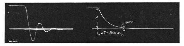
Fig. 24. Kapazität 134  $\mu$ F, kein Entladewiderstand.
