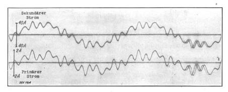
Fig. 3. Verzerrung der Stromkurve durch angeschlossenen Kondensator. Dreiphasen-Transformator 280 kVA belastet mit Kondensator  $3 \times 7$  kVA.
