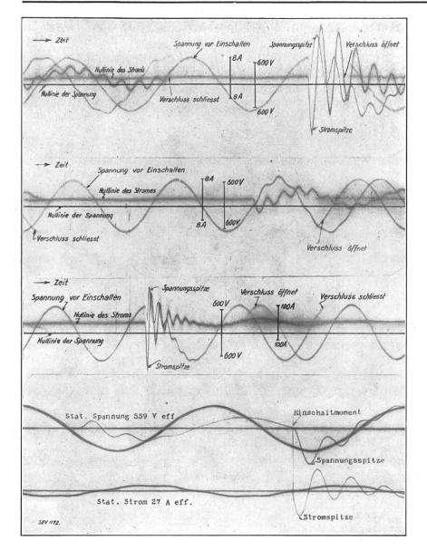
Fig. 17. Kapazität 13  $\mu \mathrm{F}$  Schaltmoment im Spannungsmaximum.
