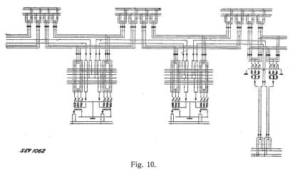
Vierleiterschaltung mit System-Trennung bei Erdschluss. Die grossen Punkte bedeuten Oelschalter, die schrägen Querstriche in den Leitern Trenner.
