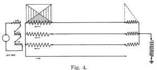
Teilspannungen bei Doppelfrequenzbetrieb.
