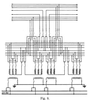
Generelles Schema eines Bahnunterwerkes 70 kV.
