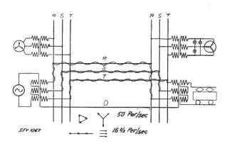
Fig. 3. Prinzip der Vierleiterschaltung.
