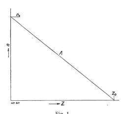
Fig. 1. Auslaufgerade  $A.\ n_0=$  Erste abgelesene Tourenzahl;  $Z_0=$  Zahl der Umdrehungen von der ersten Ablesung an bis zum Stillstand.
