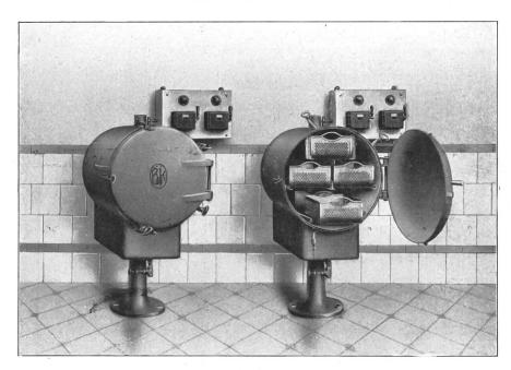
Fig. 6. Der elektrisch heizbare Kartoffeldämpfer.
