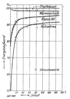
Fig. 3. Anheizverluste.
