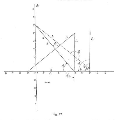
T berücksichtigen wir durch einen Strom  $I_0$  (Fig. 22), der zusammen mit  $I_3$  und  $I_4$  den resultierenden Transformatorstrom  $I_2$  liefert.
