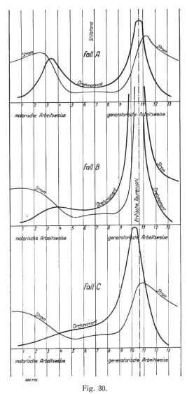
Strom- und Drehmomentkurven der Schaltung nach Fig. 25 für die Fälle A, B und C im Liniendiagramm.
