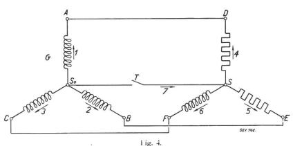
Unsymmetrische Belastung eines Dreiphasensystems.
