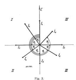
Zerlegung der Stromebene in die charakteristischen 4 Quadranten.
