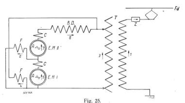
Schema einer besondern Einphasennutzbremsschaltung.
