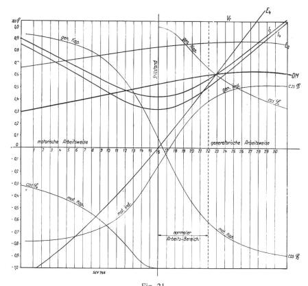
Fig. 24. Charakteristische Kurven der Einphasennutzbremsschaltung System Oerlikon (gemäss Diagramm Fig. 23.)
