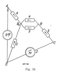
Modifiziertes Ersatzschema des Transformators.
