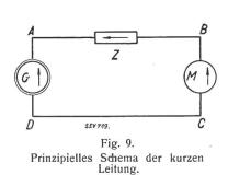
Von allen Leitungsproblemen interessiert uns am meisten die folgende Frage: Der Generator G liefere eine feste Spannung E. Am Ende der Leitung befinde sich eine variable aber proportionale Impedanz M, die durch ihr Admittanzdiagramm (bezogen auf die feste Spannung E) gegeben sei. Es interessiert uns vor allem zu erfahren, welche Spannung an den Klemmen von M herrscht und welchen Strom die Impedanz M unter dieser Spannung aufnehmen wird. Auf den ersten Blick erscheint die Lösung recht schwierig.
