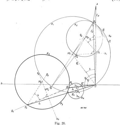
Diagramm des Transformators für konstante Primärspannung und konstante sekundäre Phasenverschiebung aber variablen Strom.
