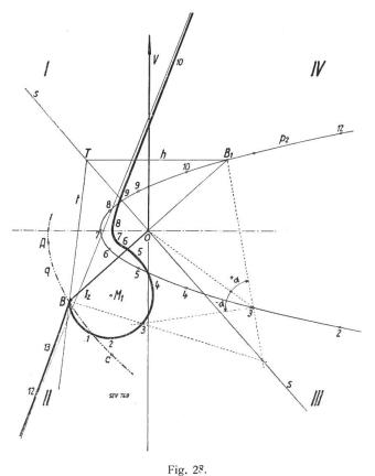
Diagramm der Schaltung nach Fig. 25 Fall B. Die bizirkulare Quartik degeneriert zur zirkularen Kubik (Resonanzfall).
