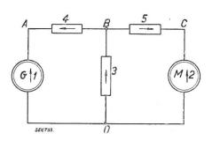
Fig. 15. Ersatzschema des Transformators.
