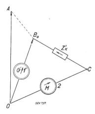
Fig. 17. Vereinfachtes Ersatzschema des Transformators.
