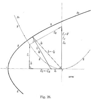
Ideales Diagramm der Schaltung nach Fig. 25. Die Ortskurve des Primärstromes ist eine Parabel.
