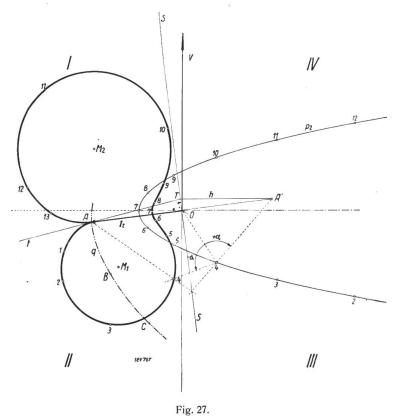
Konstruktion des wirklichen Diagrammes der Schaltung nach Fig. 25. Die Parabel verwandelt sich in eine bizirkulare Quartik mit Rückkehrpunkt. Fall A (Herzform).
