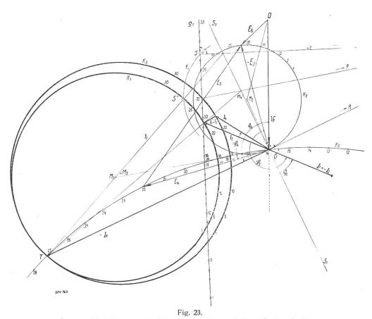
Genaues Kreisdiagramm der Einphasennutzbremsschaltung System Oerlikon.
