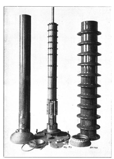
Fig. 3. W-O Wandler in Teile zerlegt.
