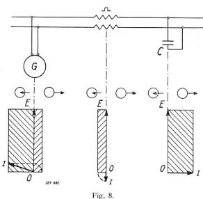
Speisung einer leerlaufenden Fernleitung mit grosser Kapazität. Ist die dem Generator aus der Kapazität zufliessende Blindleistung grösser als für die Erregung auf die normale Spannung erforderlich ist, so tritt Spannungserhöhung ein.
